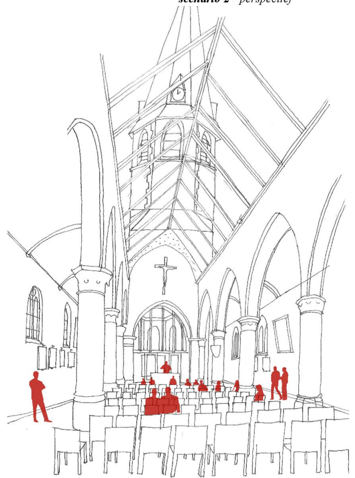
daklicht boven schip - afscheiding vergaderruimte
