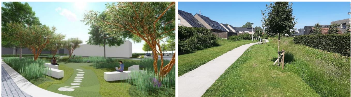
Figuur 134: Voorbeelden van wat er in een centrale groenzone kan qua waterelementen. Links enkele wadi's geïntegreerd in een parkzone en rechts een open buffergracht die door de wijk kan lopen. Beide opties zijn ook combineerbaar in de wijk het Koeksken.
