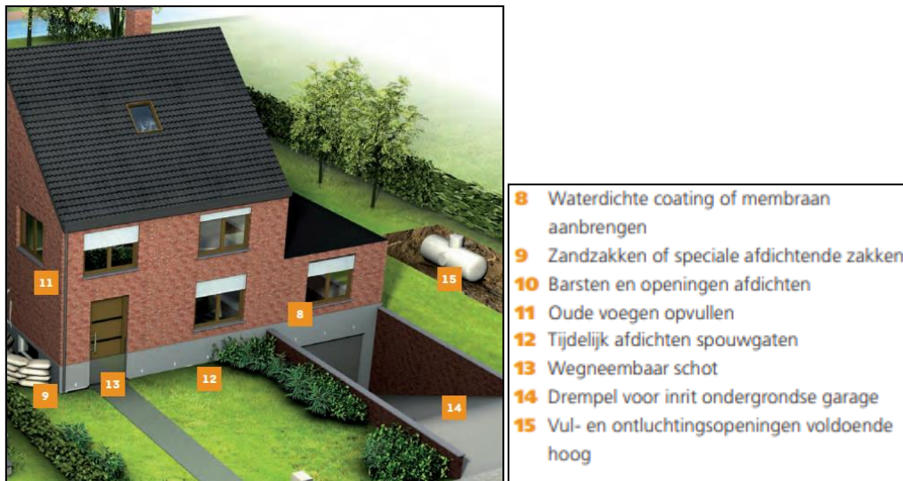
Figuur 91: Overstromingsgevoelig bouwen bij een bestaande woning (Integraal Waterbeleid; (Integraal Waterbeleid, 2011))
