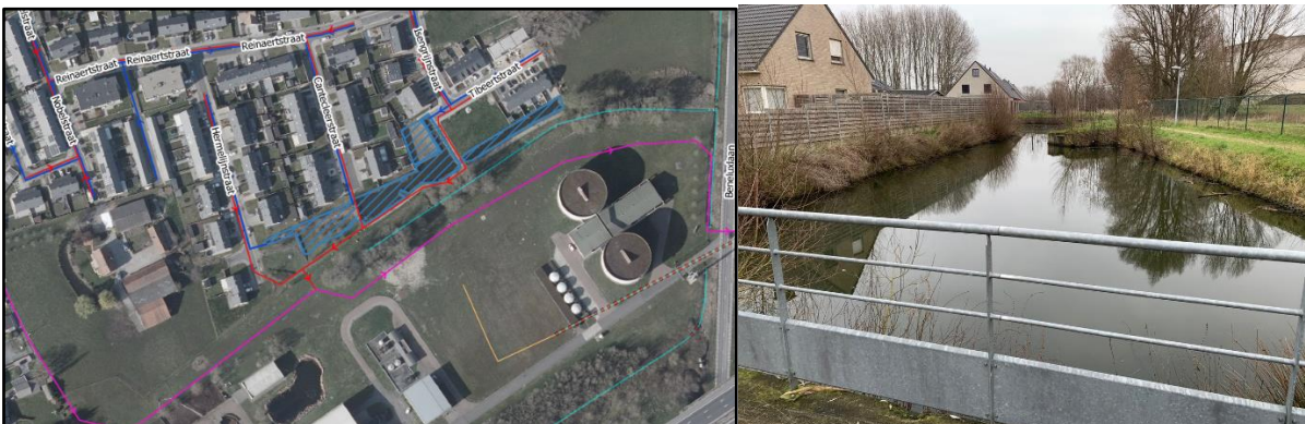
Figuur 38: In het zuiden is het waterproductiecentrum te zien. Verder is de wijk ook volledig gescheiden en komt het regenwater in het bufferbekken terecht.
