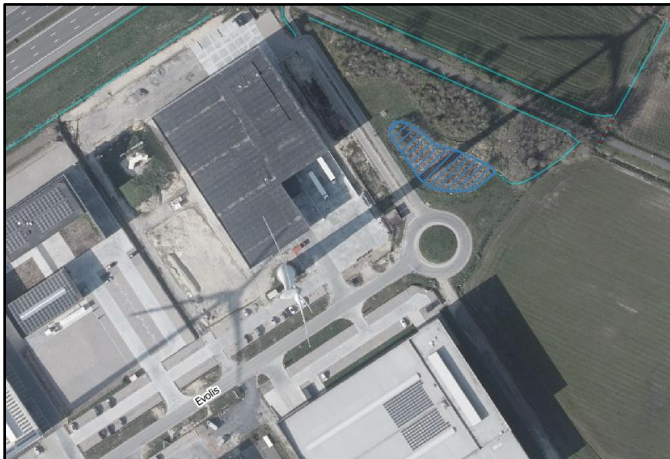
Figuur 40: Het water dat hier valt concentreert zich op de locatie van de buffer, nu komt het echter in de buffer terecht en loopt dan van daarover in de gracht.
