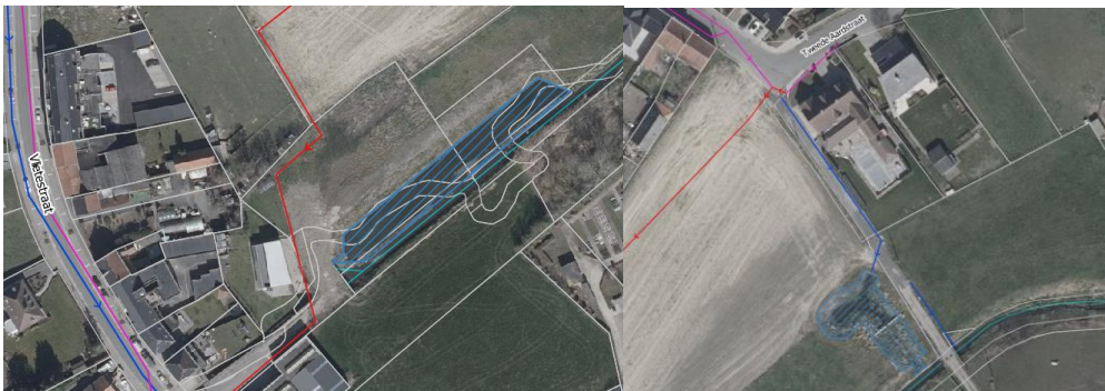
Figuur 42: Twee vooroeverbekkens die dienen om het eerste overstortwater te ontvangen, alvorens dit op de beek verder worden geloosd.
