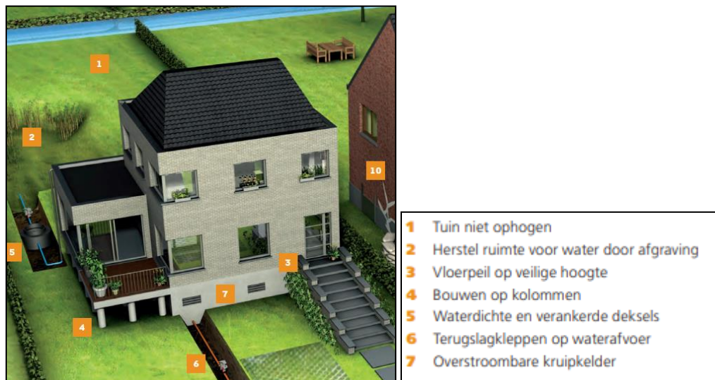
Figuur 92: Overstromingsgevoelig bouwen bij een nieuwe woning (Integraal Waterbeleid; (Integraal Waterbeleid, 2011))
