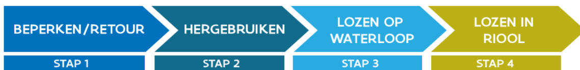
Figuur 94: Mogelijke stappen bij bemaling van grondwater (VMM, sd)
