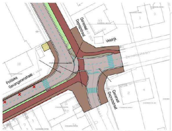
Figuur 62: Ontwerpprincipe kruispunt Gen. Deprezstraat x Pol. Gevangenenstraat – voorrangssituatie 8
